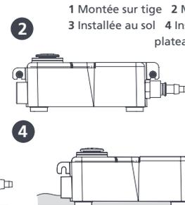
1 Montée sur tige 2 Montée au mur
