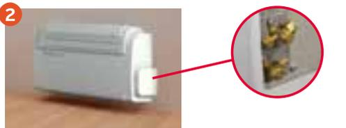
On raccorde l'unité MASTER à l'unité WALL, grâce aux robinets réfrigérants logés dans la partie droite de l'unité. Longueur maximum des lignes réfrigérantes de 10 mètres.
