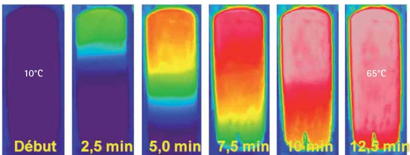
Exemple : Chargement du ballon inox 50 litres de la CGW-20 kW de 10° à 65°C
